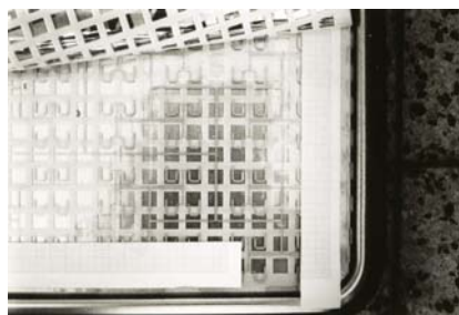
Obr.11 Plochá anténa pro sat. příjem tv vých dipólů.
