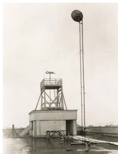
Obr.6 měření letadlové antény
