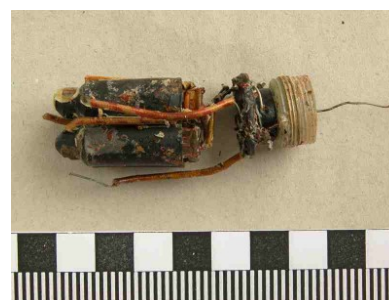
obr.1c elektronky s ladicím obvodem
